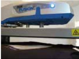
Wir empfehlen, jedes Textil 3-5 Sekunden bei der angegebenen Anpresstemperatur vorzudrucken, um die textileigene Feuchtigkeit zu entfernen und Faltenbildung beim Andruck zu vermeiden. Danach legen Sie Ihr Motiv mit der Trägerfolie nach oben an die gewünschte Andruckposition. Ist Ihr Druck platziert, decken Sie den Druck und Ihr Textil mit einem Abdeckbogen ab (s. Zubehör auf [www.blue-future.com](http://www.blue-future.com)).
